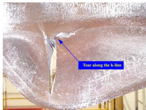
شکل ۷- محل شروع گسیختگی در آزمایش [۵]
