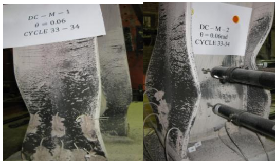
شکل ۷- محل تشکیل مفصل پلاستیک در اتصال مستقیم
