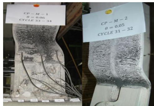
شکل ۶- محل تشکیل مفصل پلاستیک در اتصال با ورق پوششی
