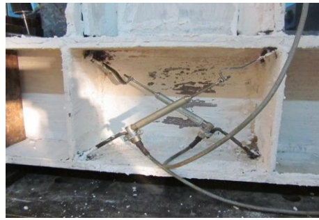
شکل ۴: جاری شدن همزمان چشمه اتصال با تیر
