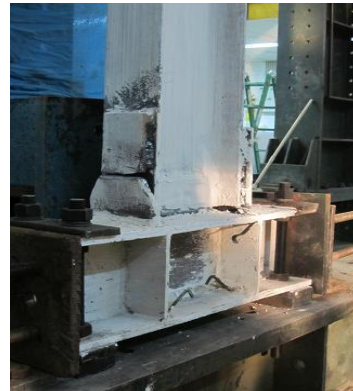
شکل ۵: اولین کسپختگی در ورق بالاسری اتصال
