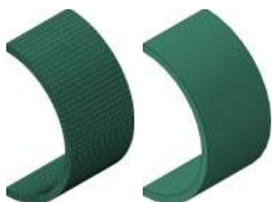
شکل ۱۵- پیکربندی و مش بندی میراگر U شکل
