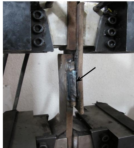
ب) نحوه گسیختگی جوش با میلگرد در دستگاه کشش
