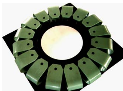
شکل (۲): میراگر جاری شونده U شکل با چیدمان دایره‌ای شکل [۵]
