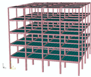
شکل (۳): ساختمان ۵ طبقه فولادی
