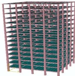
شکل (۵): ساختمان ۱۵ طبقه فولادی
