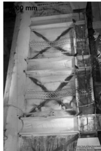
شکل (۱۱): عکس نمونه آزمایشگاهی در لحظه تسلیم و شکل گیری میدان کشش و همچنین بعد از آزمایش
