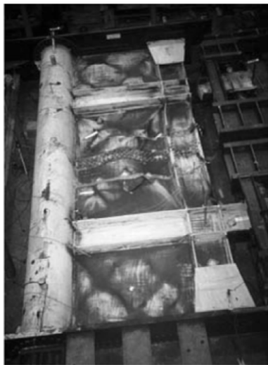
شکل (۱۱): عکس نمونه آزمایشگاهی در لحظه تسلیم و شکل گیری میدان کشش و همچنین بعد از آزمایش
