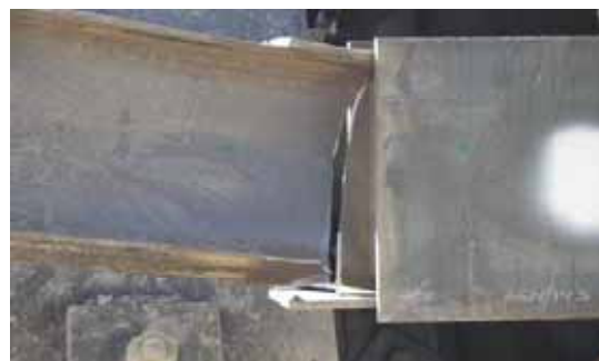
شکل (۵): شکست در مدل تحلیلی و آزمایشگاهی
