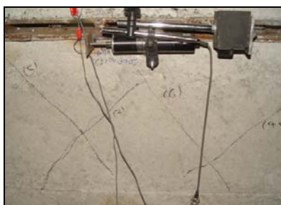
شکل (۷): ترک های مایل در میانقاب نمونه EIF-1
