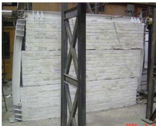
شکل (۱): تغییر مکان جانبی نمونه SF-10B-5C-10B در خیز ۷/۱۳ [۱۵]
