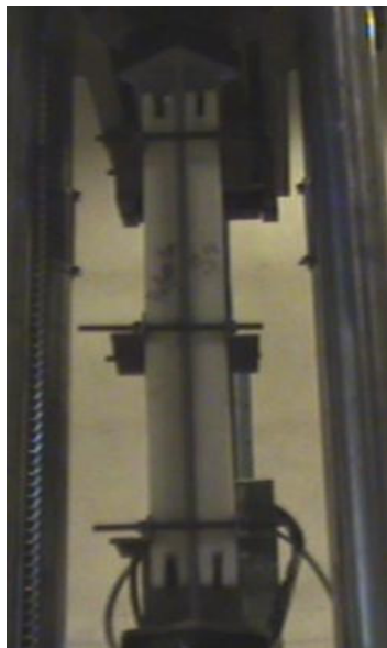
شکل (۷): بادبند با پوسته پلی اتیلنی با محور ضعیف، قبل و بعد از کمانش (نمونه S1)
