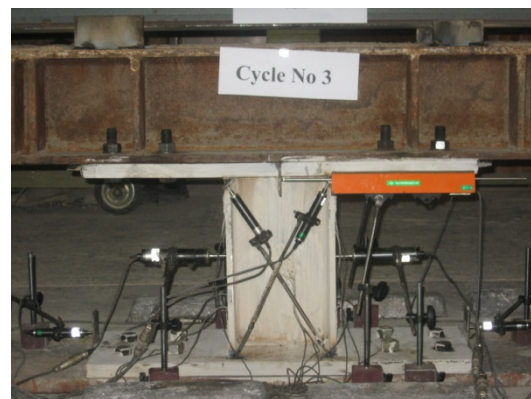
شکل (۱۴): نمونه در لحظه تسلیم
