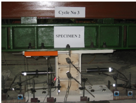
شکل (۱۷): نمونه در لحظه تسلیم
