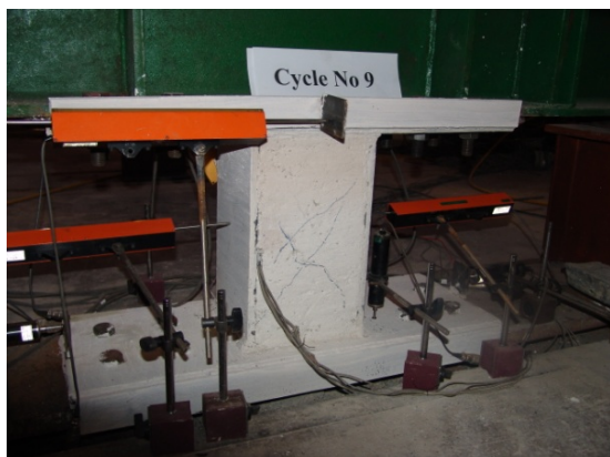
شکل (۲۳): ایجاد ترک های اولیه در بتن نمونه چهارم
