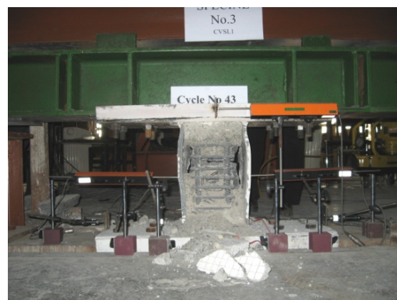
شکل (۲۱): گسیختگی نمونه سوم
