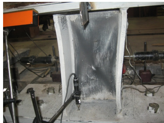
شکل (۱۵): گسیختگی پانل برشی از وسط نمونه
