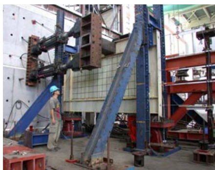
شکل (۸): جزئیات نمونه آزمایشی دیوار برشی فولادی یک طبقه S2 [۲۲]
