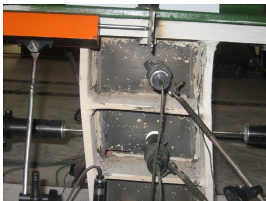
شکل (۱۸): گسیختگی پانل برشی از کناره‌های سخت کننده
