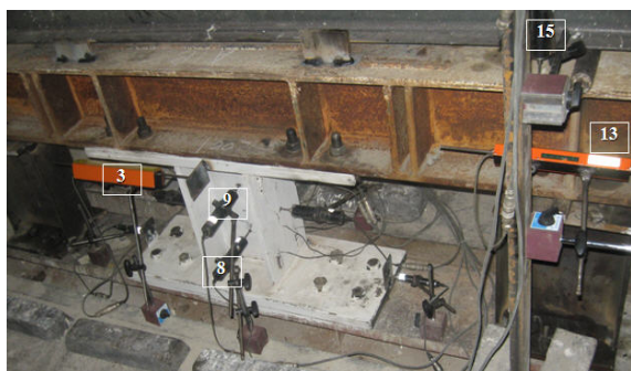
شکل (۱۱): آرایش تغییر مکان سنج‌ها (LVDT) در نمونه‌ها
