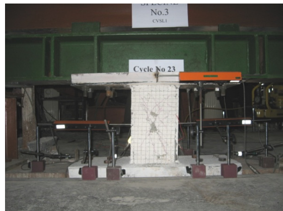
شکل (۲۰): گسترش ترک در بتن نمونه سوم
