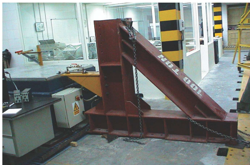
شکل (۴) : نحوه اتصال میراگر به میز لرزان
