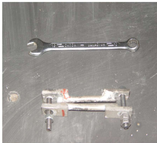
شکل (۱۴): مکانیزم تنظیم جریان روغن
