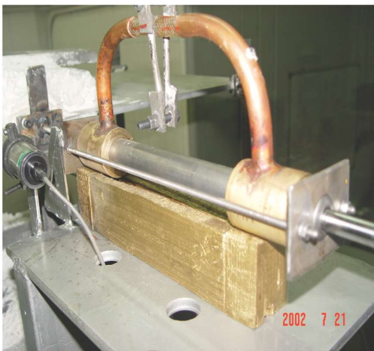
شکل (۱۵): نمونه چهارم میراگر ویسکوز
