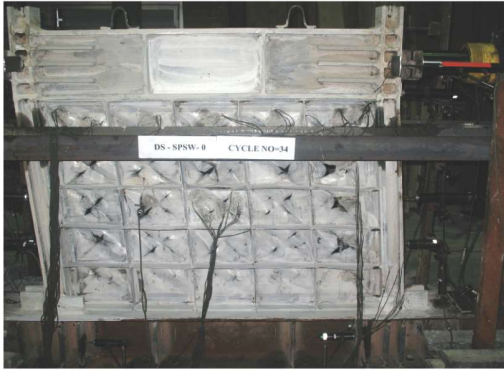
شکل (۴): تغییر شکل نمونه آزمایشگاهی دیوار برشی فولادی با سخت کننده در تغییر مکان ۶۱/۸ میلیمتر
