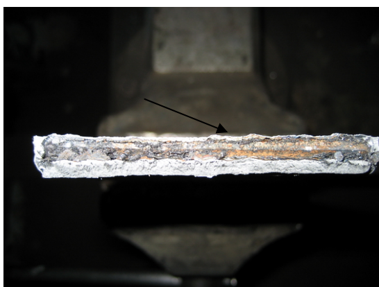
شکل (۵): نفوذ ناقص در جوش نفوذ کامل بدون پشت‌بند
