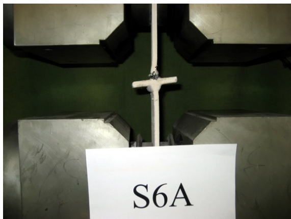
شکل (۱۶): مکانیزم گسیختگی جوش گوشه یک طرفه
