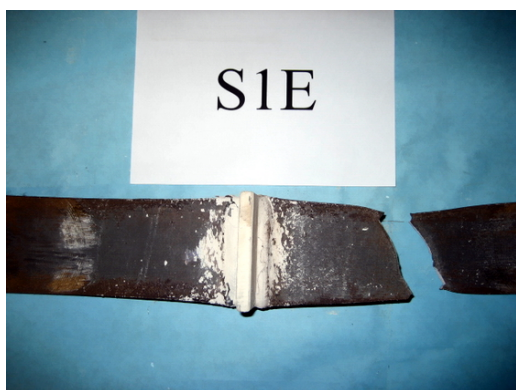
شکل (۷): منحنی رفتاری نمونه‌های S1E، S1D، S1C و S1F (بالا)، گسیختگی شکل‌پذیر S1E (پایین)
