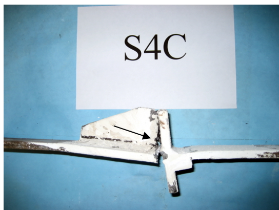
شکل (۱۳): مکانیزم گسیختگی ورق تقویت شده توسط سخت‌کننده مثلثی (لچکی) و محل تمرکز تنش
