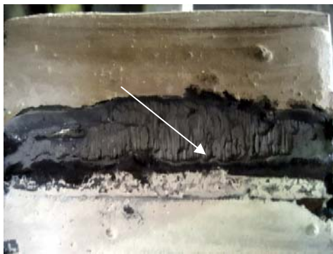
شکل (۹): ساختار درشت دانه فولاد حرارت دیده
