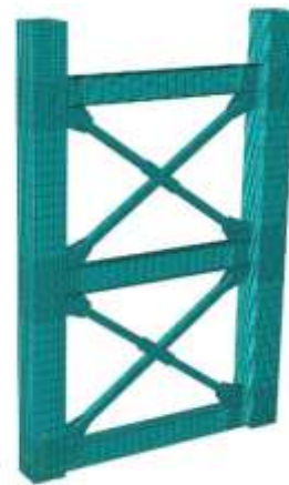
شکل ۱۸- نمای کلی از قاب تحلیل شده در نرم افزار آباکوس
