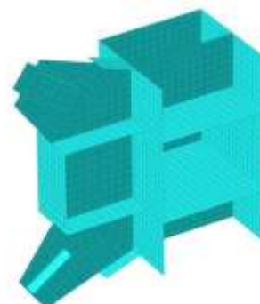
شکل ۲۰- نحوه تعبیه سخت‌کننده عمودی در محل اتصال
