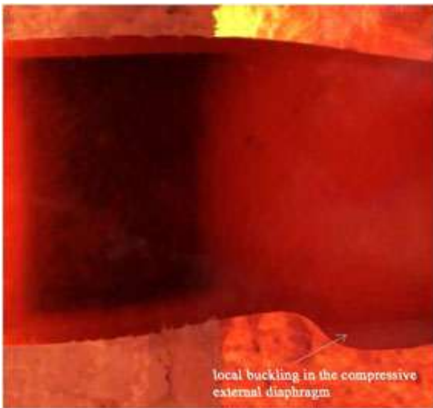
شکل ۱۰- نمایی از پاسخ یکی از اتصالات تیر اشکل به ستون لوله‌ای در برابر آتش‌سوزی [۱۸]
