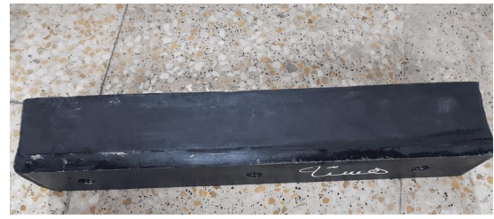
شکل ۷- یک نمونه الاستومر نئوپرن
