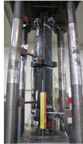
شکل ۱۴- نمونه اول کمانش تاب با غلاف بتنی در سامانه انجام آزمایش تک محوری
