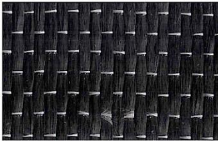
شکل ۴- بافت ظاهری الیاف پلیمری کربن مورد استفاده در غلاف مهاربند کامانش تاب
