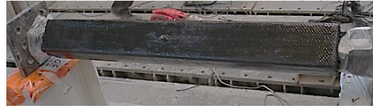
شکل ۱۱- اجرای پوشش الیاف پلیمری کربن بر روی نمونه کمانش‌تاب با غلاف بتنی
