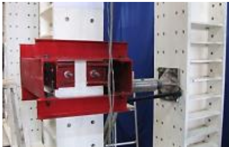
شکل ۲۵- جزئیات مهارجانبی نمونه قاب جزء (نمونه دوم)
