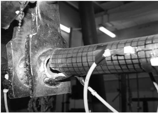
شکل (۴): لوله تحت پیچش در اثر بار محوری بصورت کششی و فشاری
