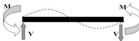
شکل (۴): نمایش نیروهای ایجاد شده در اجزاء پیوند [۱۸]
