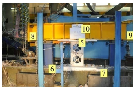
شکل (۱۰): نمایش برخی از تغییر مکان سنج‌های نصب شده بر روی نمونه‌های آزمایشگاهی
