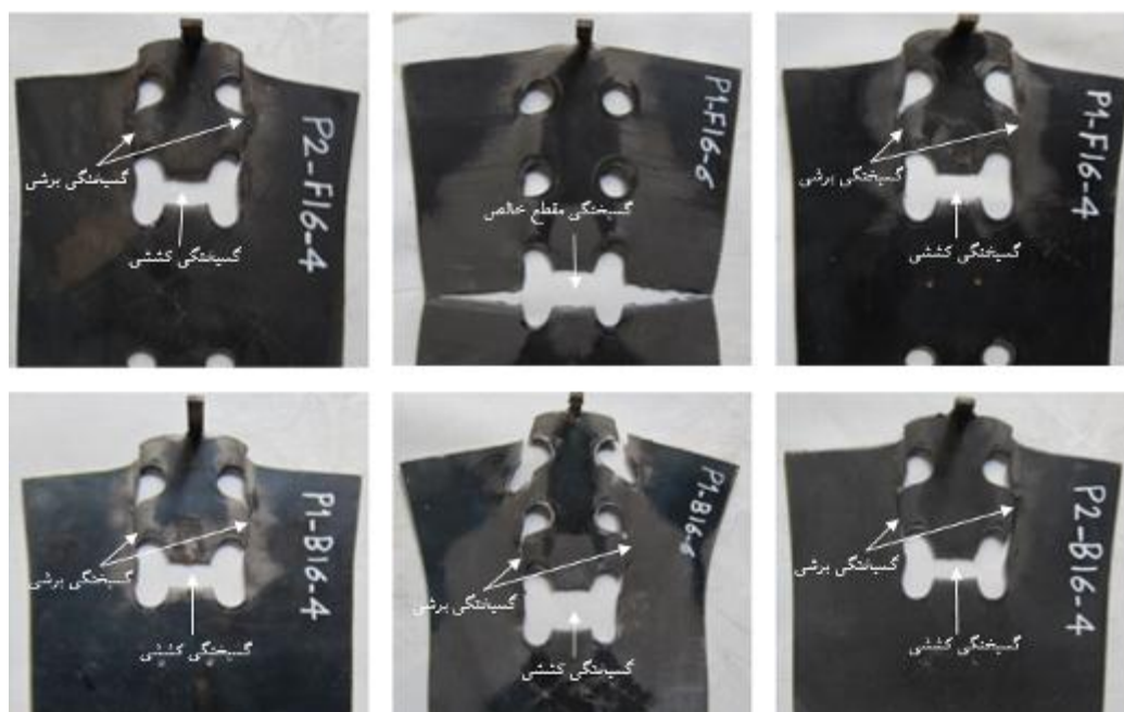
شکل ۶- مسیر شکست نمونه‌های آزمایش
