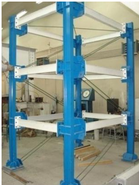
شکل ۱- قاب سه طبقه فولادی [۹]
