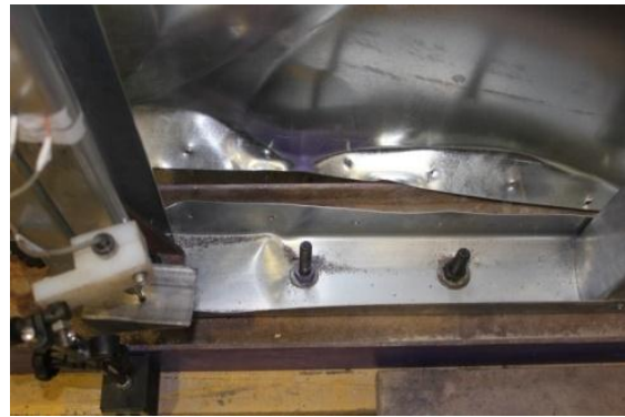
شکل ۶- کمانش و بالا آمدگی تیرک
