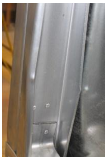
شکل ۵- کمانش موضعی ستونک
