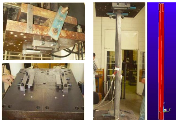
شکل ۲- طرز قرار گیری نمونه در تکیه‌گاه مفصلی [۷]
