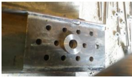
شکل ۲۱- اتصال واشر و صفحه (S1) به تیر
