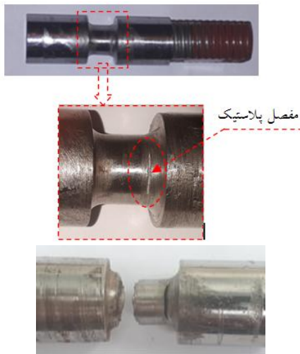
شکل ۳۴- دو نمونه میراگرهای بازگشایی شده پس از اتمام آزمایش
