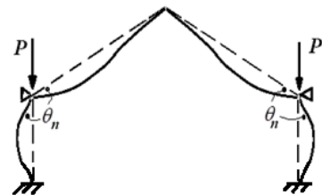
(ب) سوله با تکیه‌گاه‌های گیردار (سازه II)
