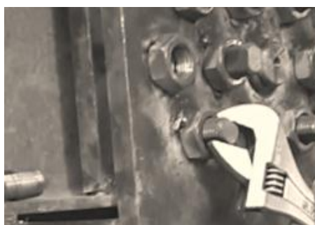
شکل ۲۳- محکم کردن میراگر در مهره توسط آچار
