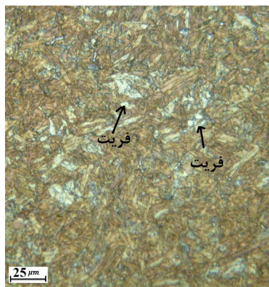
شکل ۷- ریزساختار میکروسکوپ نوری ناحیه SZ در روش FSSW (حرف F نشان دهنده فریت می‌باشد).
