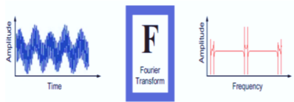
شکل ۲- تبدیل فوری، یک تکنیک ریاضی (نگاشت) برای تغییر دیدگاه ما از سیگنال بر پایه زمان به سیگنال بر پایه فرکانس
