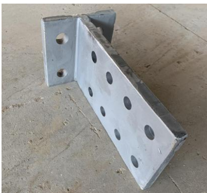
شکل ۵- برشکاری، جوشکاری و سوراخکاری بال و جان سپری
