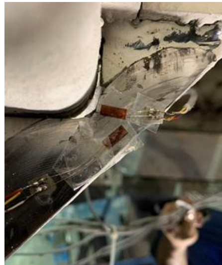
شکل ۹- کرنش سنج‌های چسبانده شده روی دیافراگم خارجی در نمونه TSTBOD
