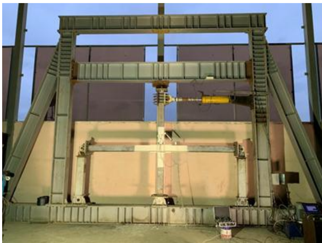
شکل ۸- پیکربندی کلی نمونه‌ها در قاب صلب بارگذاری آزمایشگاه
