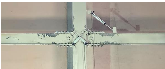
شکل ۱۱- تغییرشکل نمونه TSTB در دوران نسبی ۰/۰۸ رادیان
