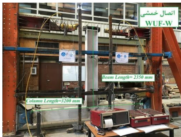
شکل ۱۲- برپایش یکی از زیرسازه‌های اتصال خمشی WUF-W در آزمایشگاه سازه
