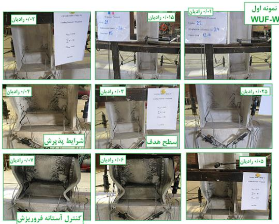
شکل ۱۵- نمونه اول اتصال خمشی WUF-W در مقادیر هدف، شرایط پذیرش و کنترل آستانه فروریزش پروتکل ملی
