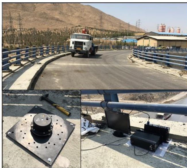
شکل ۶- آزمون میدانی پل با استفاده از شتاب‌سنج
