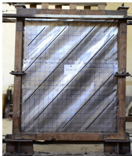
شکل ۹- شکل گیری تقریباً موازی نوارهای کششی در نمونه مورد آزمایش با نسبت عدم اتصال NCR=0.12 (جهت مشاهده امتداد نوارهای کششی از دسته خطوط موازی سیاه رنگ استفاده شده است). [۲۷]
