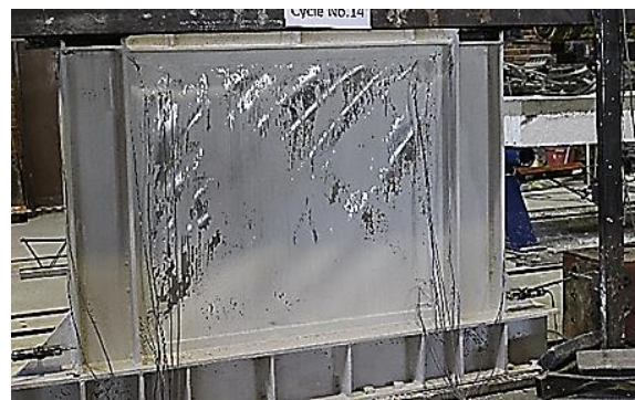
شکل ۱۰- وقوع کماتش دائمی ورق جان در جابجایی ۰/۷٪
