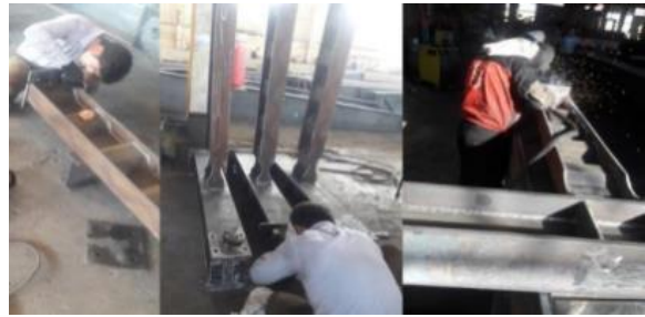
شکل ۴- نمونه اتصال ساخته شده جهت آزمایش
