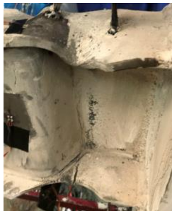
د) تغییر شکل و تشکیل مفاصل در مقطع کاهش یافته بال
