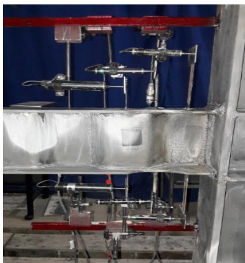
شکل ۷- موقعیت نصب جابه‌جایی سنج‌های (LVDT) نمونه‌های آزمایشی
