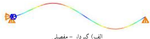
شکل ۱۷- شکل‌های مود اول المان سازه‌ای تیر فولادی با شرایط تکیه‌گاهی مختلف
