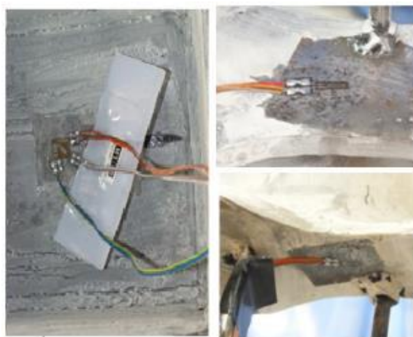
شکل ۸- موقعیت کرنش سنج‌های نصب شده در نمونه
