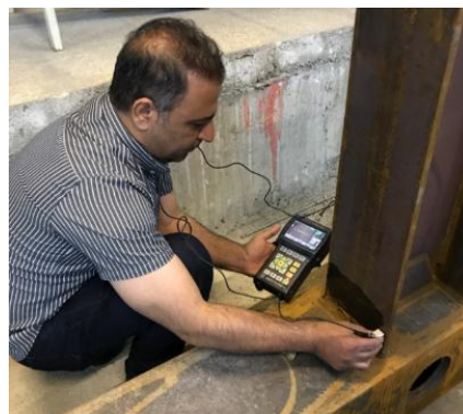
شکل ۵- انجام آزمون غیرمخرب اولتراسونیک برای کنترل کیفیت جوش‌های نمونه
