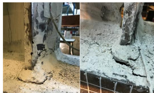
شکل ۱۱- پارگی جوش اتصال بال تیر به بال ستون در نمونه N01
