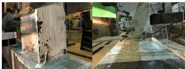
شکل ۱۲- عدم تشکیل مفصل پلاستیک تیر در پایان آزمایش نمونه N01
