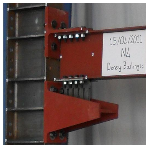
شکل ۱- اتصال گیردار مجهز به میراگر شکاف دار فولادی [۲]
