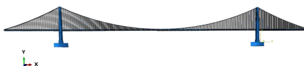
شکل ۲- مدل سازی پل گلدن گیت در نرم افزار ABAQUS بر اساس ابعاد واقعی پل
