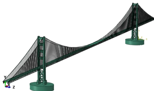
شکل ۳- مدل سازی پل گلدن گیت در نرم افزار ABAQUS و اختصاص مصالح فولادی به آن
