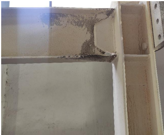
شکل ۴- تشکیل مفصل پلاستیک در تیر قاب WUF-W
