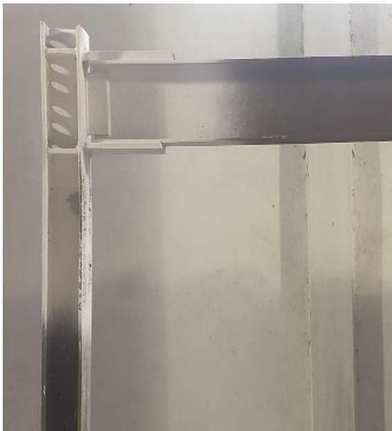
شکل ۵- تشکیل مفصل پلاستیک در ستون در قاب WFP
