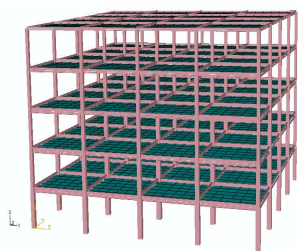
شکل (۳): ساختمان ۵ طبقه فولادی
