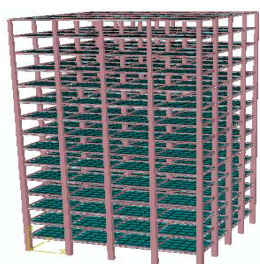
شکل (۵): ساختمان ۱۵ طبقه فولادی
