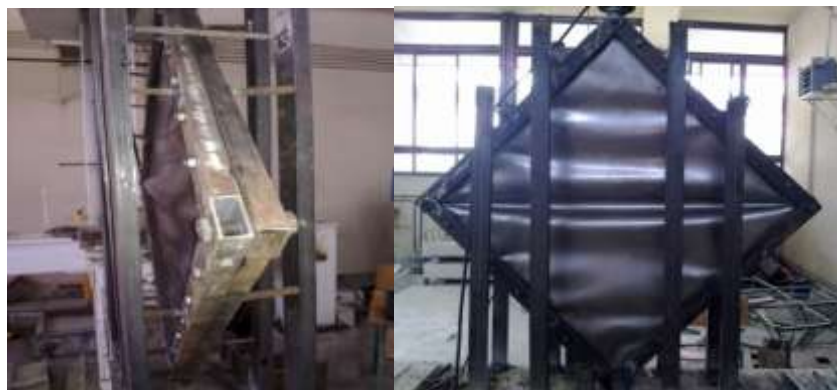
شکل (۱۰): نحوه کمانش ورق پرکننده و قاب در نمونه S_{21}
