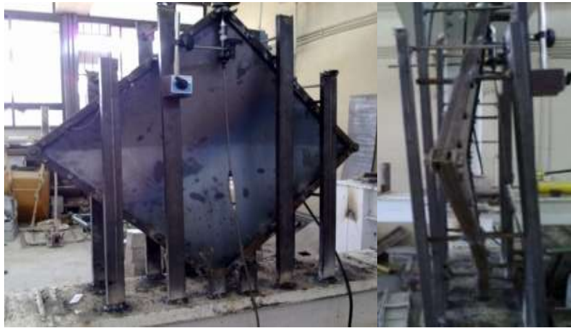
شکل (۸): نحوه کمانش ورق پرکننده و قاب در نمونه S_{14}
