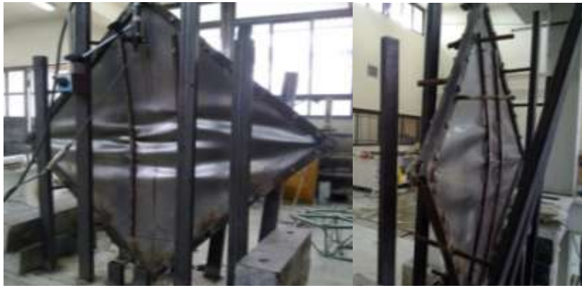
شکل (۷): نحوه کمانش ورق پرکننده و قاب در نمونه S_{13}
