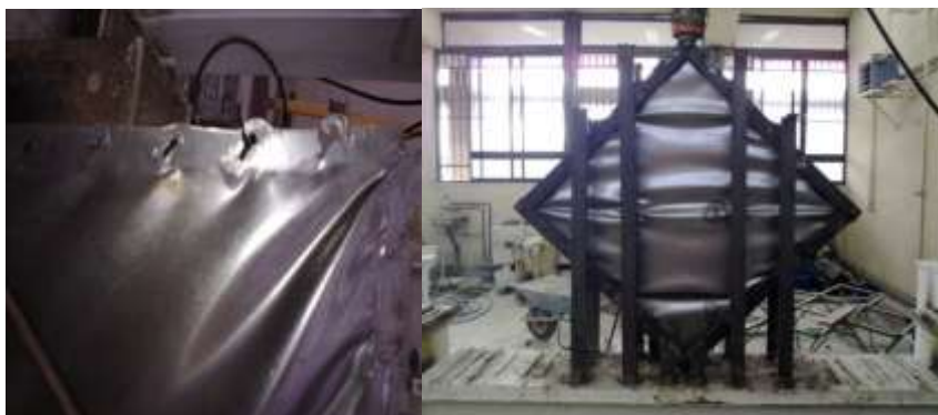
شکل (۱۱): نحوه کمانش ورق پرکننده و قاب در نمونه S_{22}
