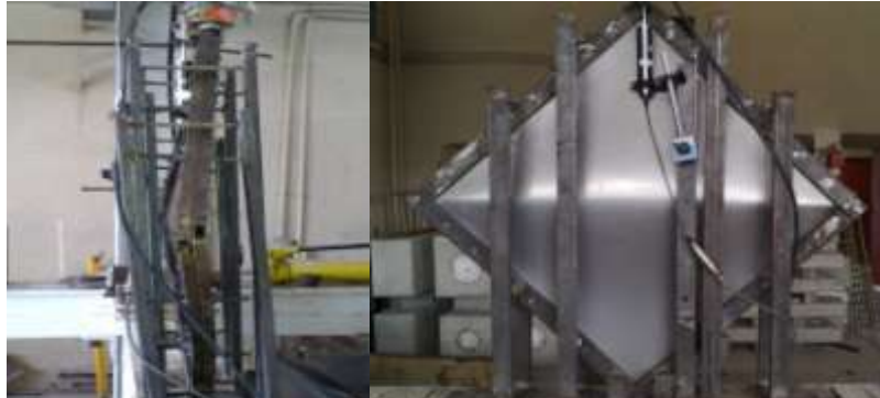
شکل (۱۳): نحوه کمانش ورق پرکننده و قاب در نمونه S_{24}
