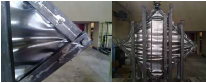
شکل (۱۲): نحوه کمانش ورق پرکننده و قاب در نمونه S_{23}
