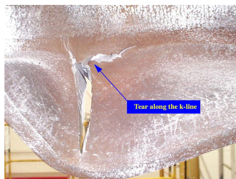
شکل ۷- محل شروع گسیختگی در آزمایش [۵]
