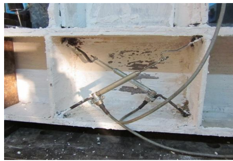
شکل ۴: جاری شدن همزمان چشمه اتصال با تیر
