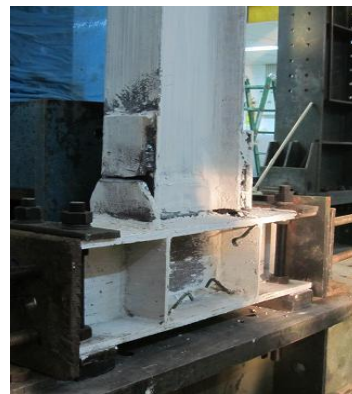
شکل ۵: اولین گسیختگی در ورق بالاسری اتصال
