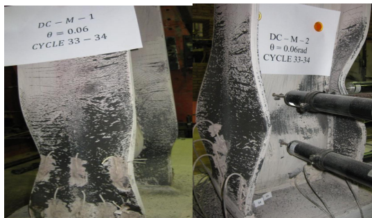
شکل ۷- محل تشکیل مفصل پلاستیک در اتصال مستقیم
