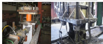
شکل (۴): نحوه اعمال نیروی محوری در نمونه‌ها.
