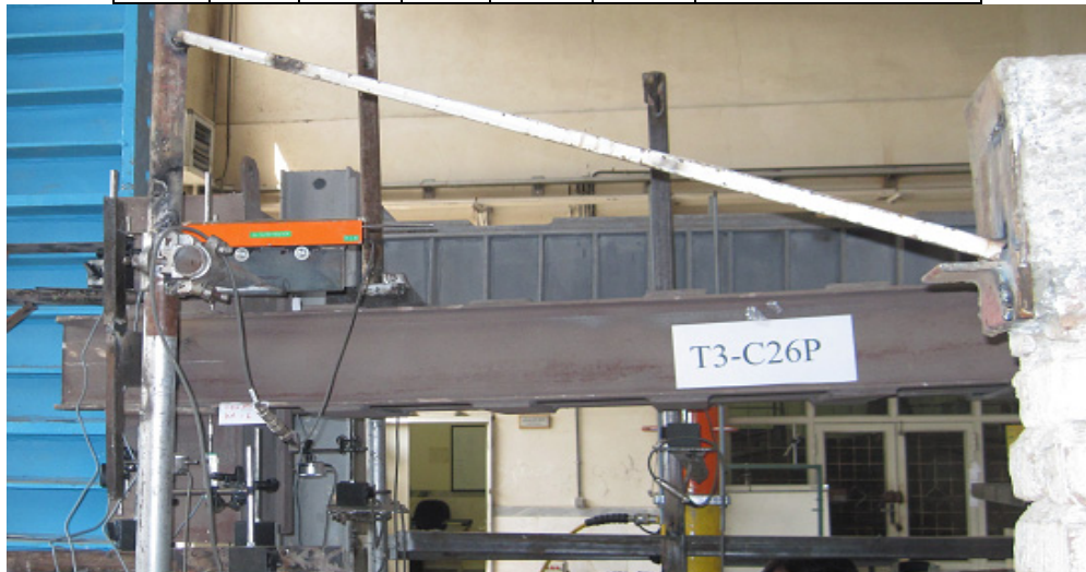
شکل (۱۷): تغییر شکل در نمونه T3 در در یکی از سیکل‌های آخر بارگذاری
