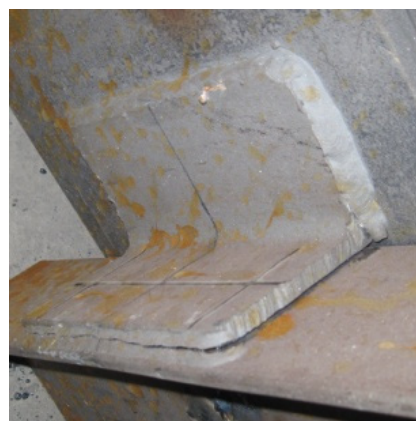
شکل (۸): تصاویری از شکستهای مشاهده شده در نمونه T2
