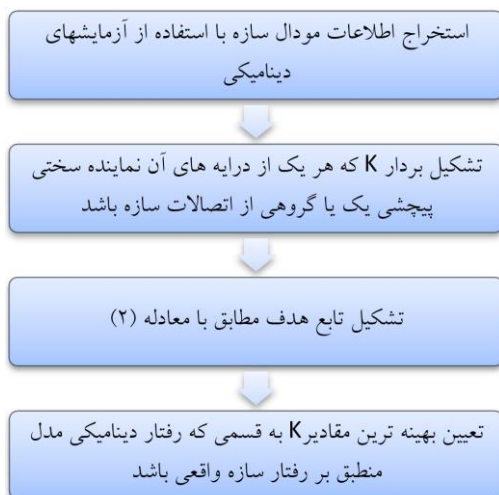
شکل ۵- الگوریتم به‌روزرسانی مدل اجزای محدود قاب فولادی با اتصالات نیمه‌صلب خورجینی
