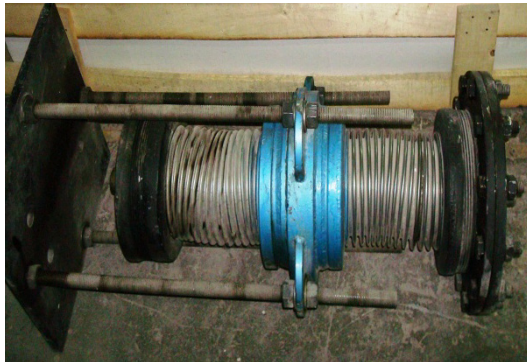
شکل (۴): نمونه‌ی اولیه ساخته شده میراگر ویسکوز [۵]
