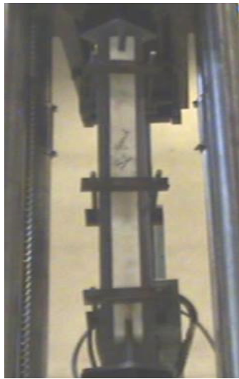
شکل (۶): بادبند با پوسته پلی اتیلنی با محور قوی ، قبل و بعد از کمانش (نمونه S2)
