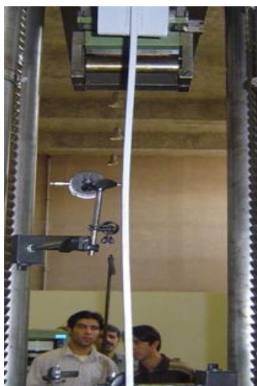
شکل (۵): نمونه A1، بادبند یا هسته تحت آزمایش فشار محوری (قبل و بعد از کماتش)
