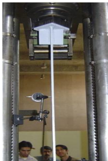
شکل (۵): نمونه A1، بادبند یا هسته تحت آزمایش فشار محوری (قبل و بعد از کماتش)
