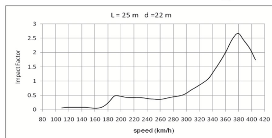
شکل (۸): تغییرات ضریب ضربه با تغییر سرعت حرکت بار برای پل با دهانه ۲۵ متر و فاصله محورهای ۲۲ متر
