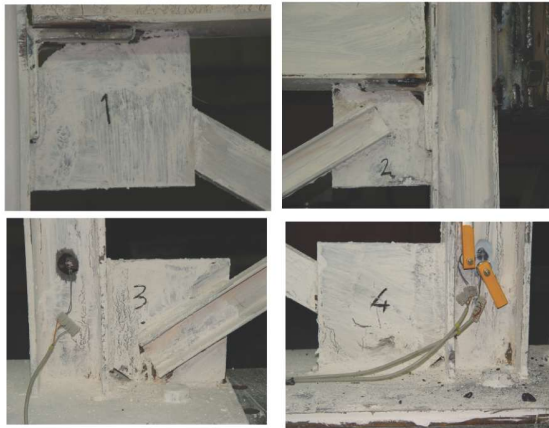
شکل (۱۲): نمای اتصالات مهاربند
