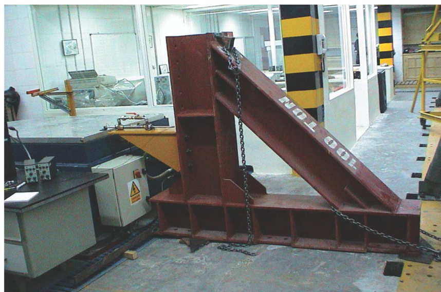
شکل (۴) : نحوه اتصال میراگر به میز لرزان
