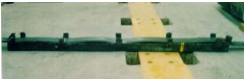
شکل (۱۲): نمونه ۲ پس از اتمام آزمایش، به تسلیم فولاد و تشکیل مودهای بالای کمناش توجه شود.
