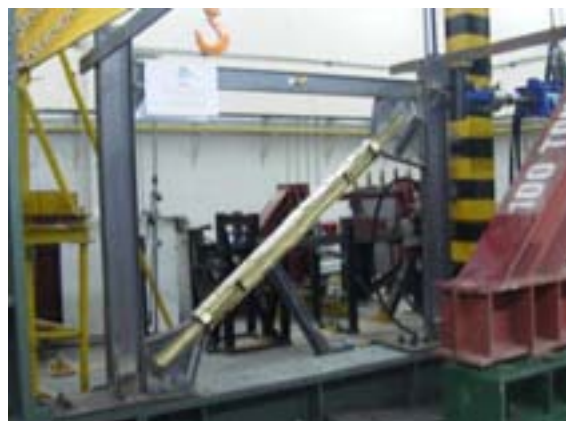
شکل (۲۰): تصویر قاب با مهاربند نمونه ۲ تحت بارگذاری
