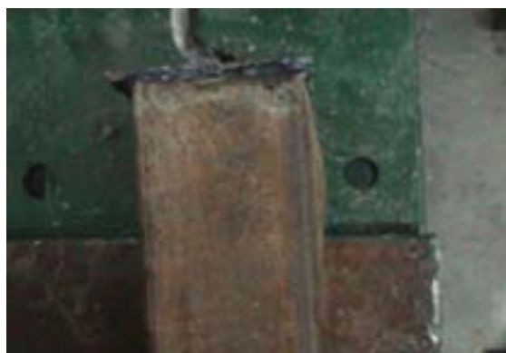
شکل (۱۷): طبله کردن غلاف فلزی و دوران هسته میانی به علت کمانش موضعی در انتهای آزمایش
