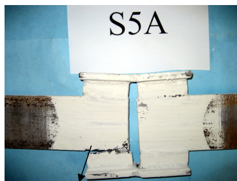
شکل (۱۴): تمرکز تنش در ابتدای جوش سخت‌کننده به ورق و گسیختگی در این نقطه
