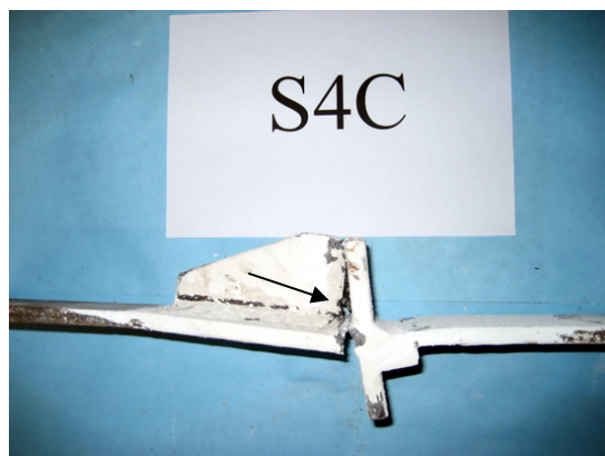
شکل (۱۳): مکانیزم گسیختگی ورق تقویت شده توسط سخت‌کننده مثلی (لچکی) و محل تمرکز تنش
