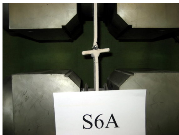
شکل (۱۶): مکانیزم گسیختگی جوش گوشه یک طرفه
