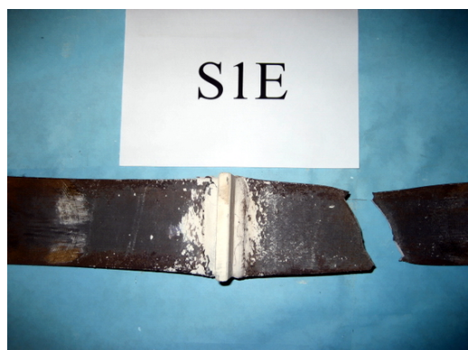
شکل (۷): منحنی رفتاری نمونه‌های S1C ، S1D ، S1E و S1F (بالا) ، گسیختگی شکل پذیر S1E (پایین)
