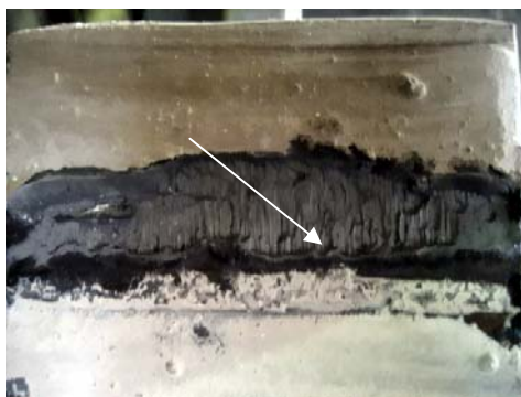
شکل (۹): ساختار درشت دانه فولاد حرارت دیده
