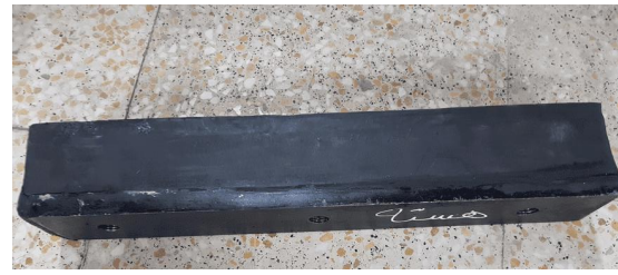
شکل ۷- یک نمونه الاستومر نئوپرن
