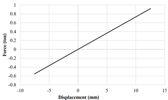
شکل ۱۸- نمودار نیرو-جابه‌جایی الاستومر
