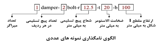
شکل ۲- مشخصات هندسی میراگر مورد بررسی (واحد mm)
