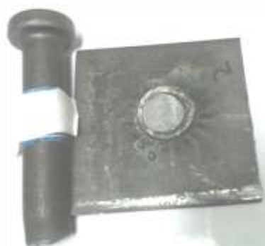
ب) نمونه‌ای که عمق جوش بیشتر و در حد بهینه است، شکست از فلز پایه اتفاق افتاده است.
