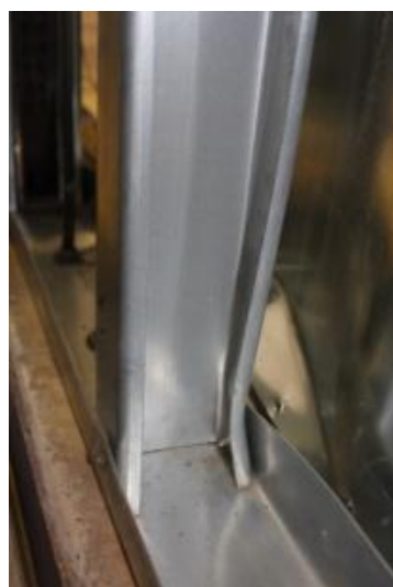
شکل ۵- کمانش موضعی ستونک
