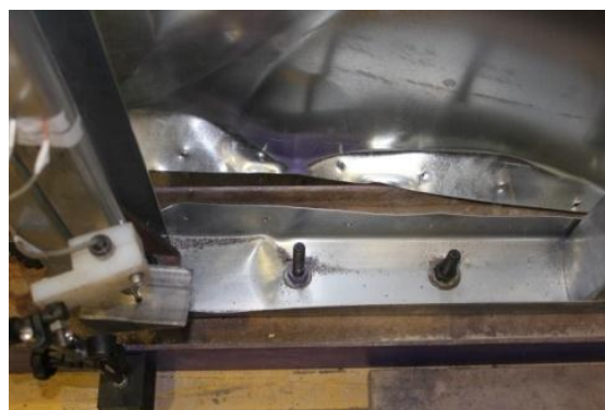
شکل ۶- کمانش و بالا آمدگی تیرک
