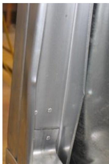
شکل ۵- کمانش موضعی ستونک
