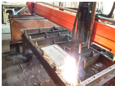
شکل ۹- برش کاری ورق فولادی با دستگاه CNC
