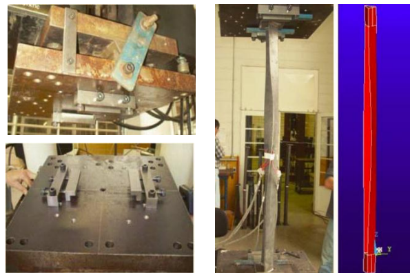
شکل ۲- طرز قرار گیری نمونه در تکیه‌گاه مفصلی [۷]
