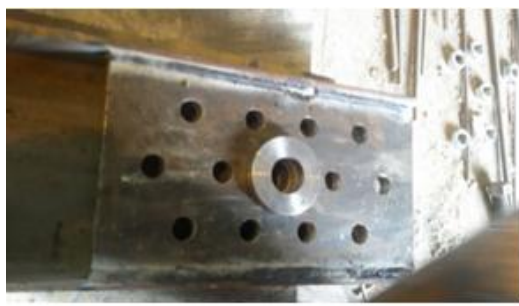
شکل ۲۱- اتصال واشر و صفحه (S1) به تیر
