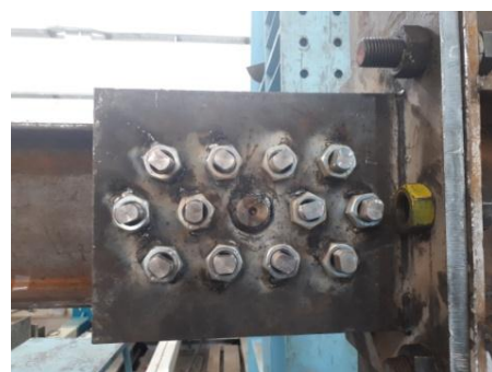
شکل ۲۵- اتصال نمونه آزمایشگاهی (CPYD1) به ستون
