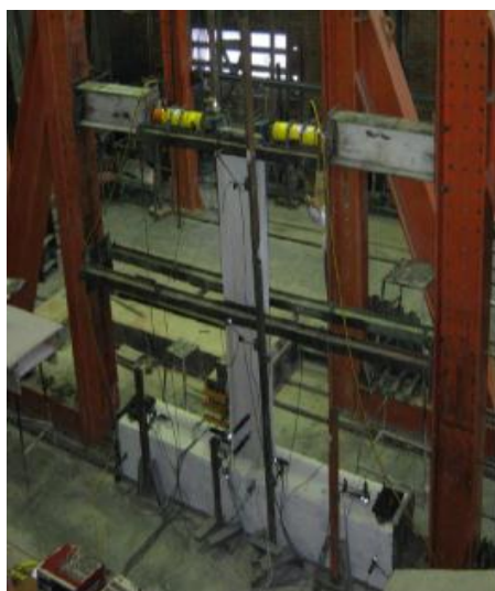
شکل ۳- جزئیات برپایی اتصال WUF-W در آزمایشگاه [۹ و ۱۰]
